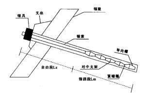
图 1 预应力锚索结构示意图
