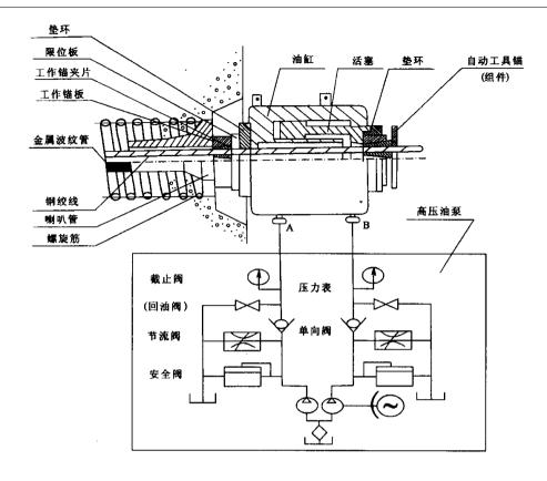
图 3 千斤顶与电动油泵连接示意图①
