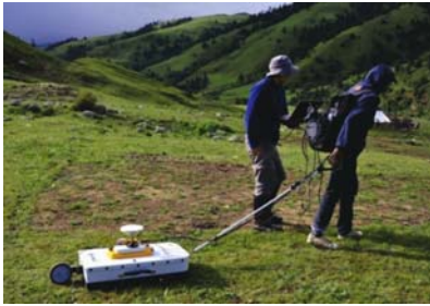
图 3 探地雷达与差分 GPS 同步采集系统
