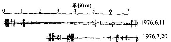
图 2 能量释放率为 75\text{MJ}/\text{m}^2 采场前试钻孔的观察结果
